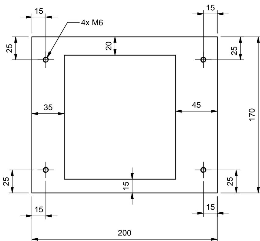
Realizzare un carter di protezione per il componente qui quotato. Utilizzare i 4 fori filettati M6 per fissare il carter. Per suggerimenti visualizzare il video allegato "MODELLO TIPO"
